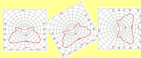
Diagramme photométrique du même luminaire pour différentes inclinaisons de support :
